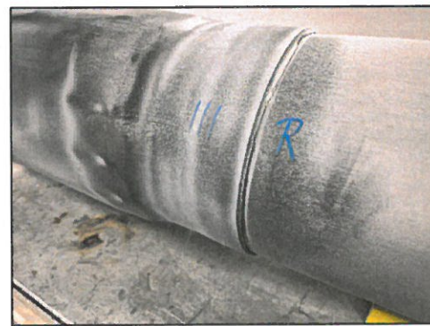
Fot. 27 ÷ 34 Obiekt LB/81/2023 po badaniu obciążenia od gruntu
