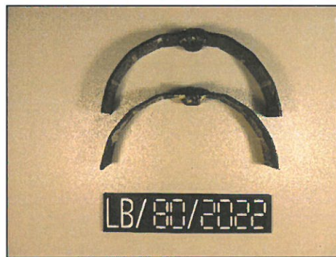
Fot. 37, 38 Próbkki LB/80/2023 przed badaniem zginania korków wgrzewanych
