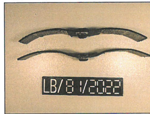
Fot. 43, 44 Próbkki LB/81/2023 po badaniu zginania korków wgrzewanych
