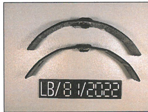
Fot. 41, 42 Próbkki LB/81/2023 przed badaniem zginania korków wgrzewanych
