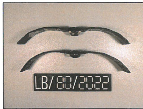
Fot. 39, 40 Próbkki LB/80/2023 po badaniu zginania korków wgrzewanych
