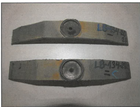
Fot. 40, 41 Próbka LB/134/2020 przed próbą zginania korków wgrzewanych
