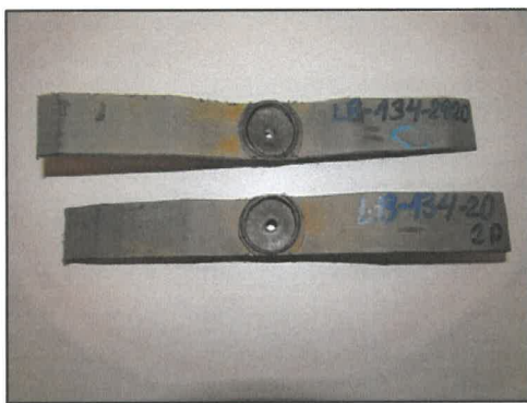
Fot. 43, 44 Próbka LB/134/2020 po próbie zginania korków wgrzewanych
