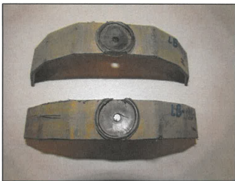
Fot. 37, 38 Próbka LB/133/2020 przed próbą zginania korków wgrzewanych
