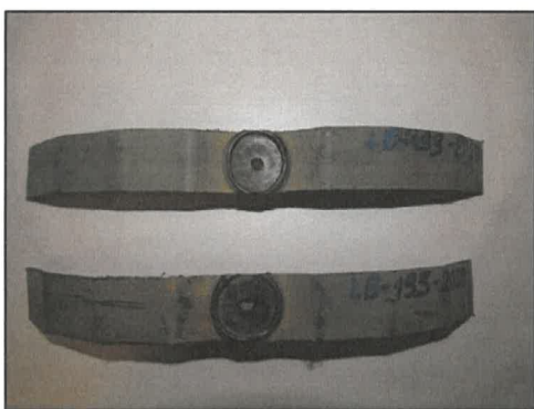
Fot. 39, 40 Próbka LB/133/2020 po próbie zginania korków wgrzewanych
