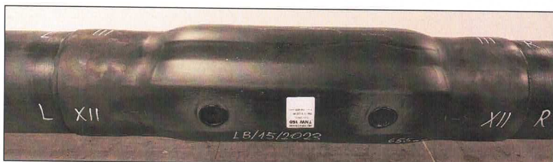
Fot. 1÷4 Obiekt badań LB/15/2023 przed badaniem obciążenia od gruntu
