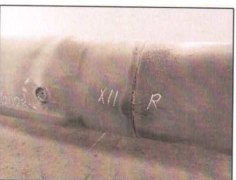
Fot. 27÷34 Obiekt badań LB/16/2023 po badaniu obciążenia od gruntu
