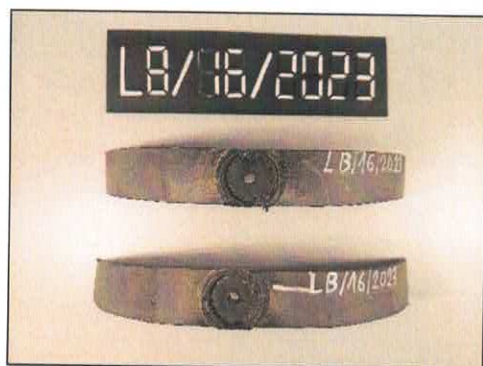
Fot. 41, 42 Próbkki LB/16/2023 po badaniu zginania korków wgrzewanych
