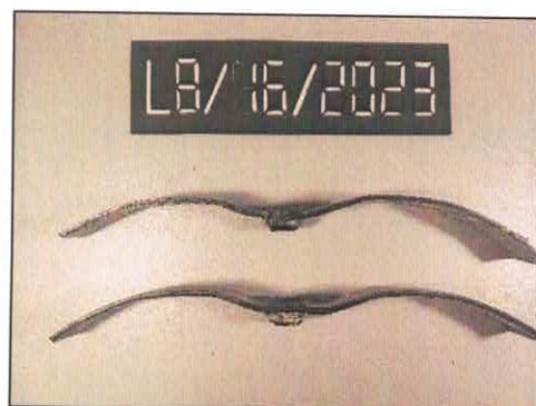
Fot. 41, 42 Próbkki LB/16/2023 po badaniu zginania korków wgrzewanych
