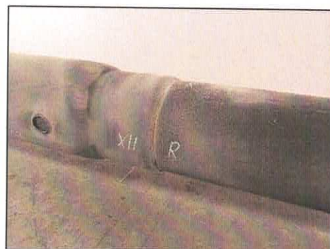
Fot. 9÷ 16 Obiekt badań LB/15/2023 po badaniu obciążenia od gruntu
