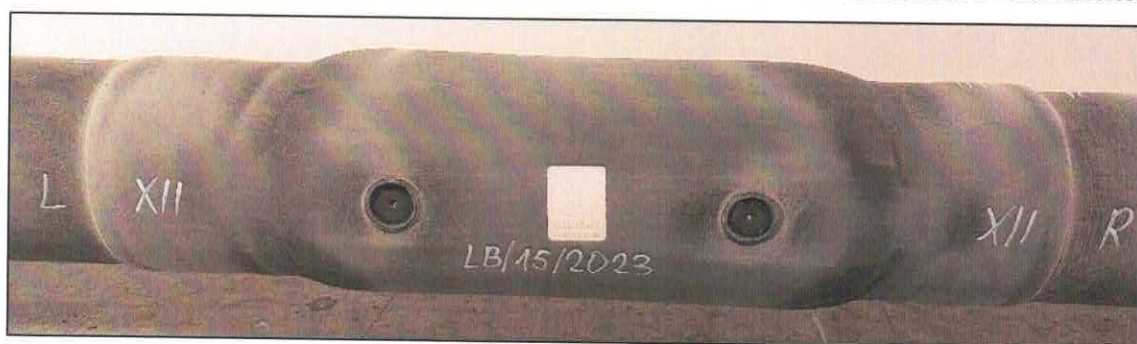
Fot. 5÷8 Obiekt badań LB/15/2023 po badaniu obciążenia od gruntu
