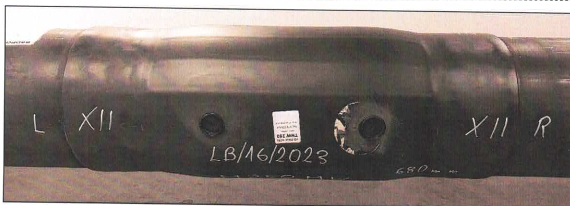
Fot. 19÷22 Obiekt badań LB/16/2023 przed badaniem obciążenia od gruntu
