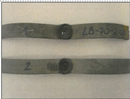
Fot. 39, 40 Próbki LB/70/2021 po próbie zginania korków wgrzewanych
