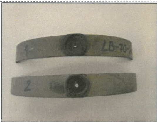
Fot. 37, 38 Próbki LB/70/2021 przed próbą zginania korków wgrzewanych
