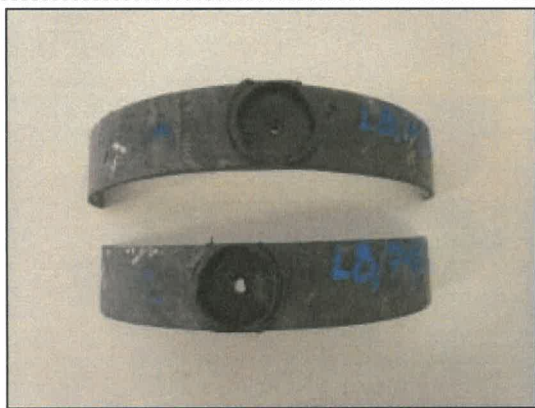
Fot. 41, 42 Próbki LB/71/2021 przed próbą zginania korków wgrzewanych
