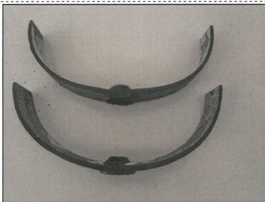
Fot. 41, 42 Próbki LB/63/2021 przed próbą zginania korków wgrzewanych
