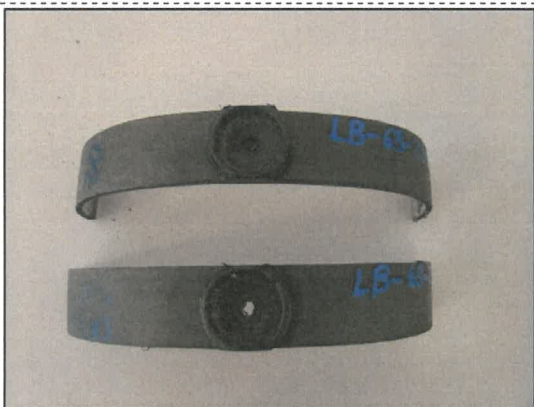
Fot. 41, 42 Próbki LB/63/2021 przed próbą zginania korków wgrzewanych
