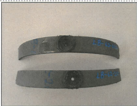
Fot. 37, 38 Próbki LB/62/2021 przed próbą zginania korków wgrzewanych
